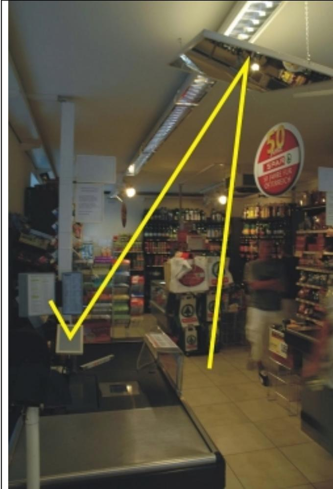
Abb. 23: Spiegelsystem beim Kassierplatz eines Supermarktes, um den Inhalt eines Einkaufswagens einsehen zu können.
