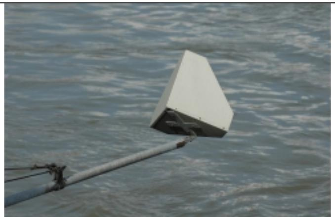
Abb. 20: „Reale“ Würfecken (Kantenlänge rund 75 cm) dienen als Radarreflektoren zur Warnung vor Hindernissen, etwa Brückenpfeilern.
