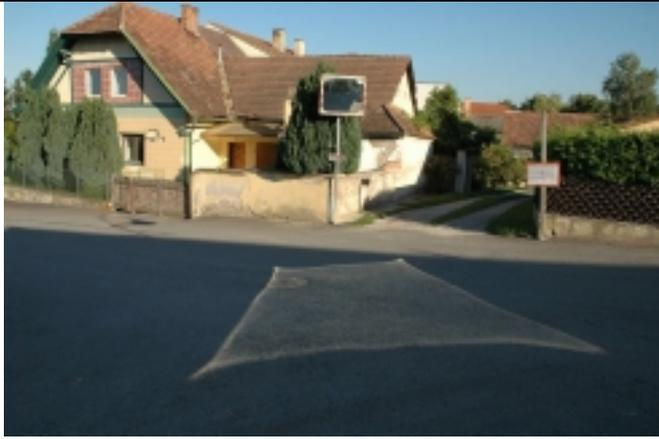
Abb. 25: Die Sonnenstrahlen werden an der Verkehrsspiegeloberfläche reflektiert und im Schattenbereich der Straße sichtbar. Die reflektierte Spiegelfläche auf der Straße entspricht in keiner Weise der erwarteten „einfach“ berandeten Figur. Eine Kugelfläche stellt natürlich nur eine grobe und sehr vereinfachende Annäherung an die tatsächliche Spiegelfläche dar.
