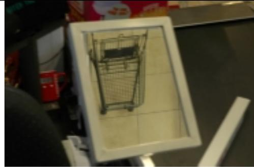
Abb. 24: So sieht man nach Reflexion an zwei ebenen Spiegeln vom Kassierplatz aus in einen Einkaufswagen.
