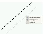
Das Kopieren geht ohne diese Auswahlabfrage schneller bei gedrückter STRG-Taste mit der linken Maustaste. Dies hat den Nachteil, dass man Maus <u>und</u> Tastatur verwenden muss.
