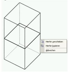
Leider "passt" die Sichtbarkeit nicht. Dies lässt sich so ändern, indem man dem erzeugten ersten Würfel eine Flächenhaut verpasst, die dahinterliegende Objekte (ganz oder zum Teil) verdeckt.
