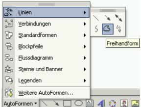
Nach Wahl des Icons für "Freihandform" in der Werkzeugleiste unter "Linien" klickt man nacheinander alle vier Punkte des oberen Begrenzungsquadratbildes des Würfels an. Der als erstes angeklickte Eckpunkt wird zum Abschluss nochmals angeklickt - dadurch wird der Polygonzug geschlossen und automatisch weiß eingefärbt. Natürlich wird nun auch ein Teil der darunterliegenden Kanten verdeckt. Die Kanten erscheinen dünner. Will man dies kompensieren, dann gibt es zwei Möglichkeiten:
