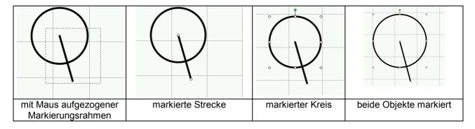
Augenblicklich markierte Objekte erkennt man an den Nullenkreisen bzw. kleinen Quadraten (Off. 97) in den Endpunkten oder am Rand. Durch Drücken der TAB-Taste kann man die Markierung von einem zum anderen Zeichenelement wandern lassen.<sup>1</sup>
